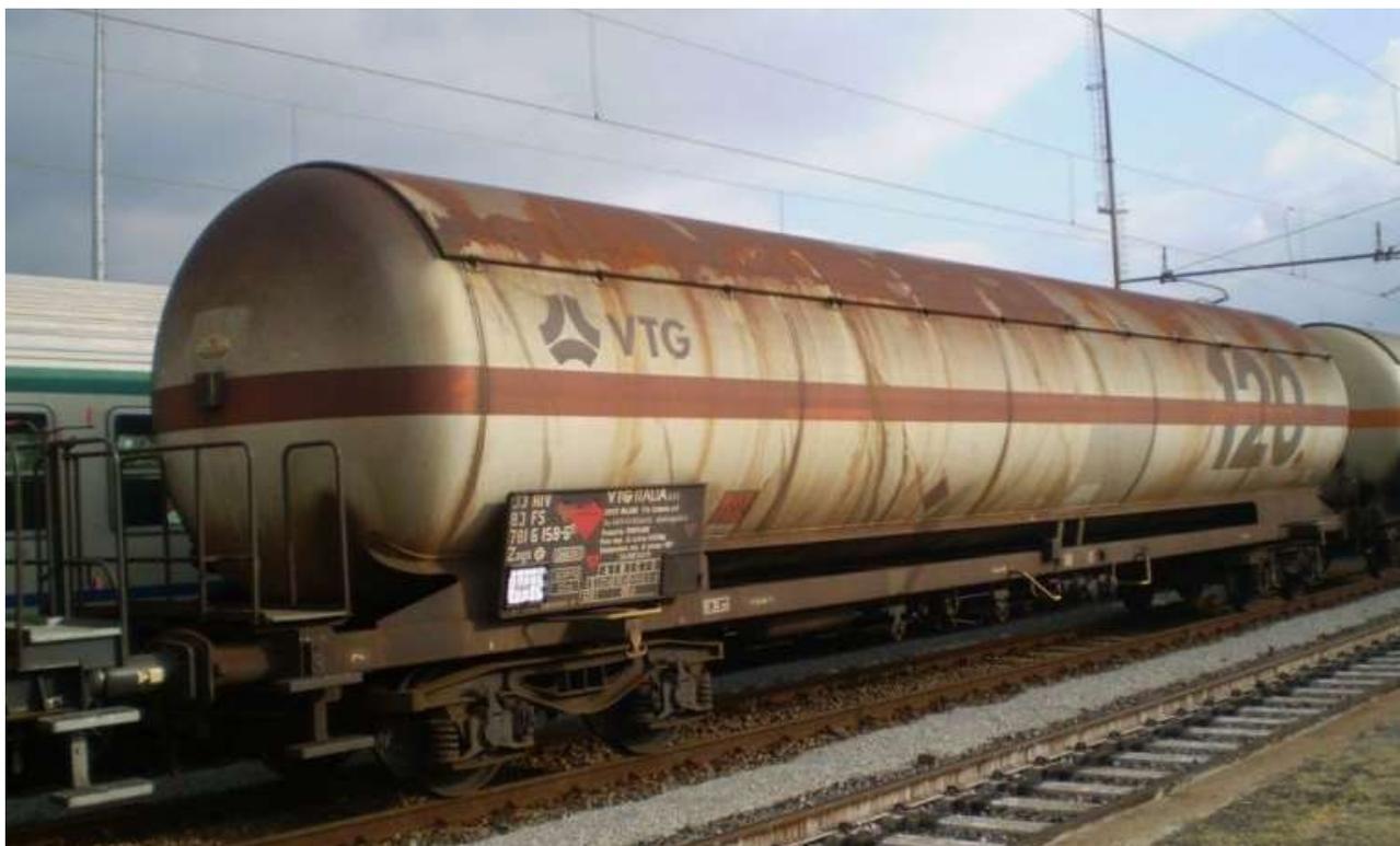
Fig. 20 – carro cisterna ZAGS gas compressi (Zags 33 83 781 6 158-6 da TMF ) Sestri\_Levante (F. Quirico)
