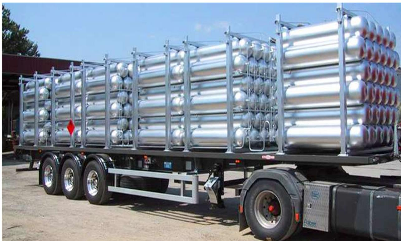
Fig. 5 “semirimorchio bombola” costituito da gruppo di bombole collegati in serie, in allestimento fisso o movimentabile (tipologia non particolarmente utilizzata) adatta al trasporto di gas tecnici quali acetilene e idrogeno
