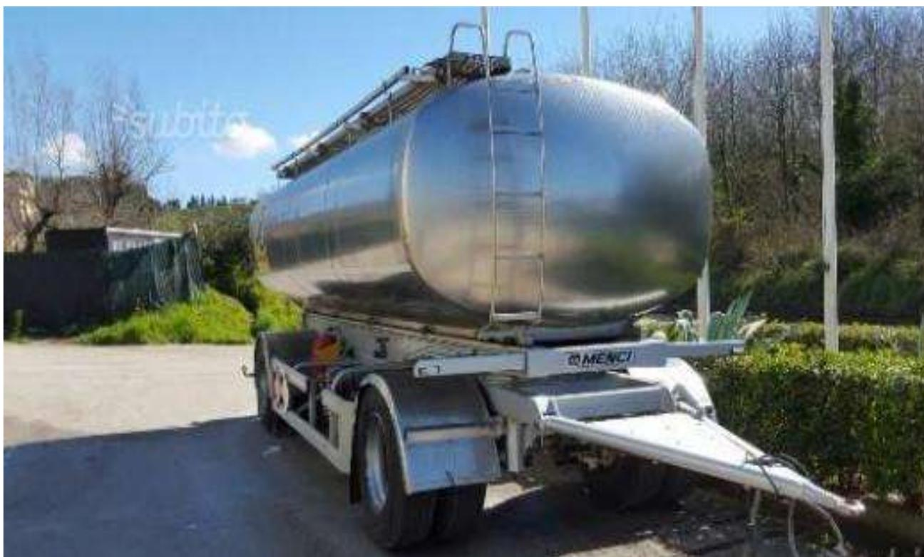
Fig.3 - Cisterne carburante della tipologia a sezione ellittica/policentrica (semirimorchio, autocarro e rimorchio) per trasporto liquidi a pressione atmosferica per prodotti a basso peso specifico quali benzina, gasolio, cherosene, benzina avio, alcool etilico
