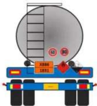
Cisterne per composti chimici liquidi (realizzata in due tipologie distinte a seconda della sezione che può essere 1) cilindrica utilizzata soprattutto per i materiali ad alto peso specifico come l'anidride solforica o gli acidi in genere 2) ellittica utilizzata per materiali ad basso peso specifico. I materiali di realizzazione dipendono strettamente dalle caratteristiche dei prodotti trasportati rispetto alla densità, viscosità, infiammabilità e di capacità corrosiva
