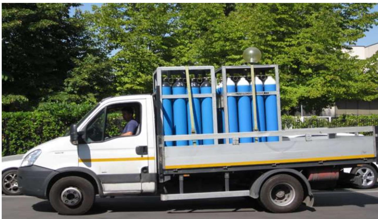
Fig. 8 autocarro cassonato per la consegna dei gas tecnici medicali e industriali quali miscele per taglio ossiacetilenico, gas per saldatura a mig o a tig, gas puri per laboratorio, gas laser per impianti laseranti e gas alimentari per il confezionamento degli alimenti e per lo spillamento di bevande, azoto liquido;
