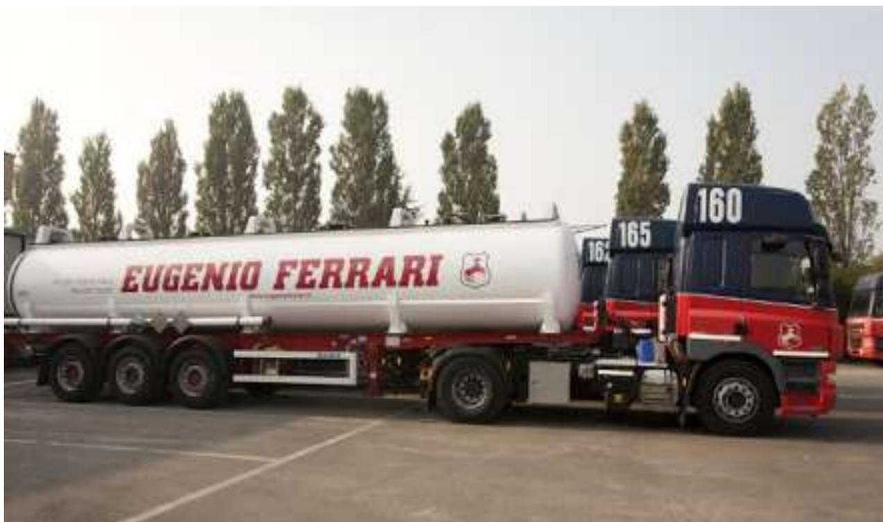
Fig. 9 - Cisterne per composti chimici liquidi (semirimorchio) nella versione più diffusa, con sezione cilindrica di ridotte dimensioni, per trasporto acidi e liquidi corrosivi
