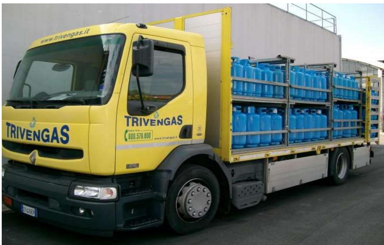
Fig. 7 autocarro cassonato per il trasporto di bombole di GPL ad uso domestico per consegna nei centri di distribuzione al dettaglio
