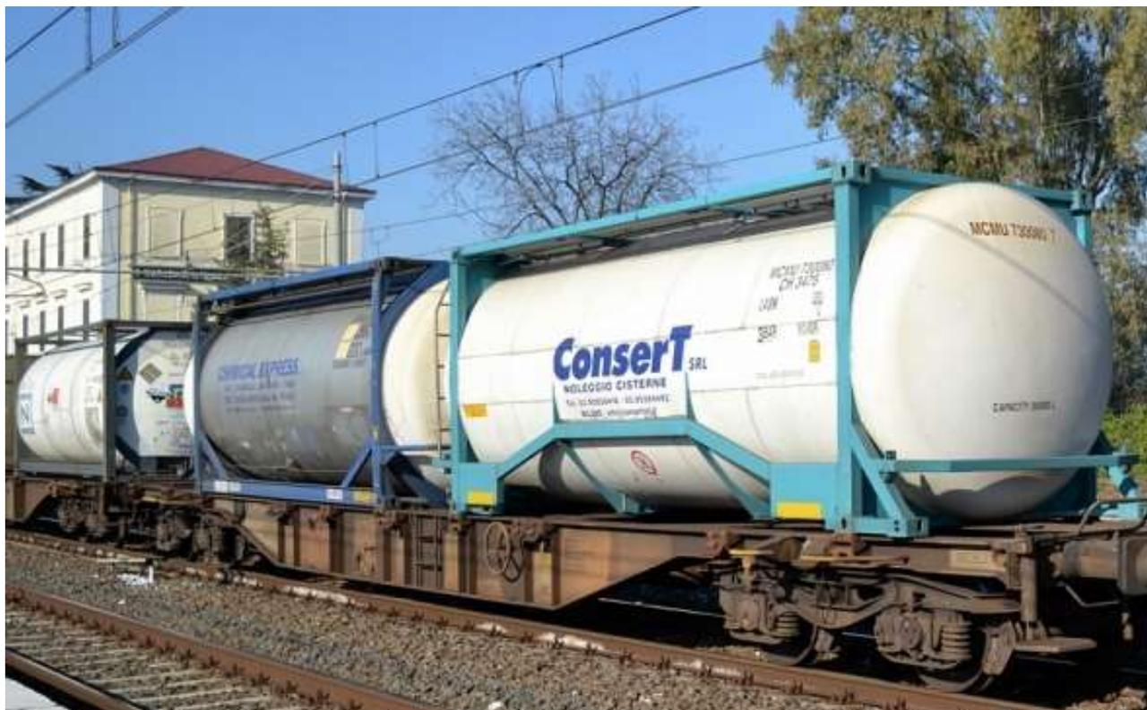
Fig. 23 - carro trasporto "tank container " (da TRM)
