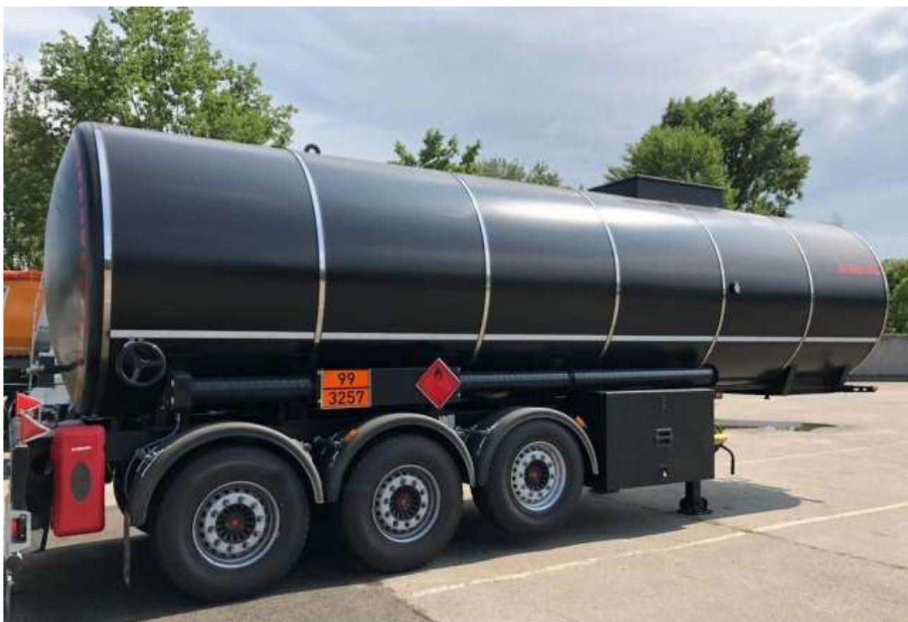
Fig. 12 – semirimorchio cisterna coibentata trasporto bitumi, emulsioni o liquidi ad alte temperature (modello di ultima generazione)
