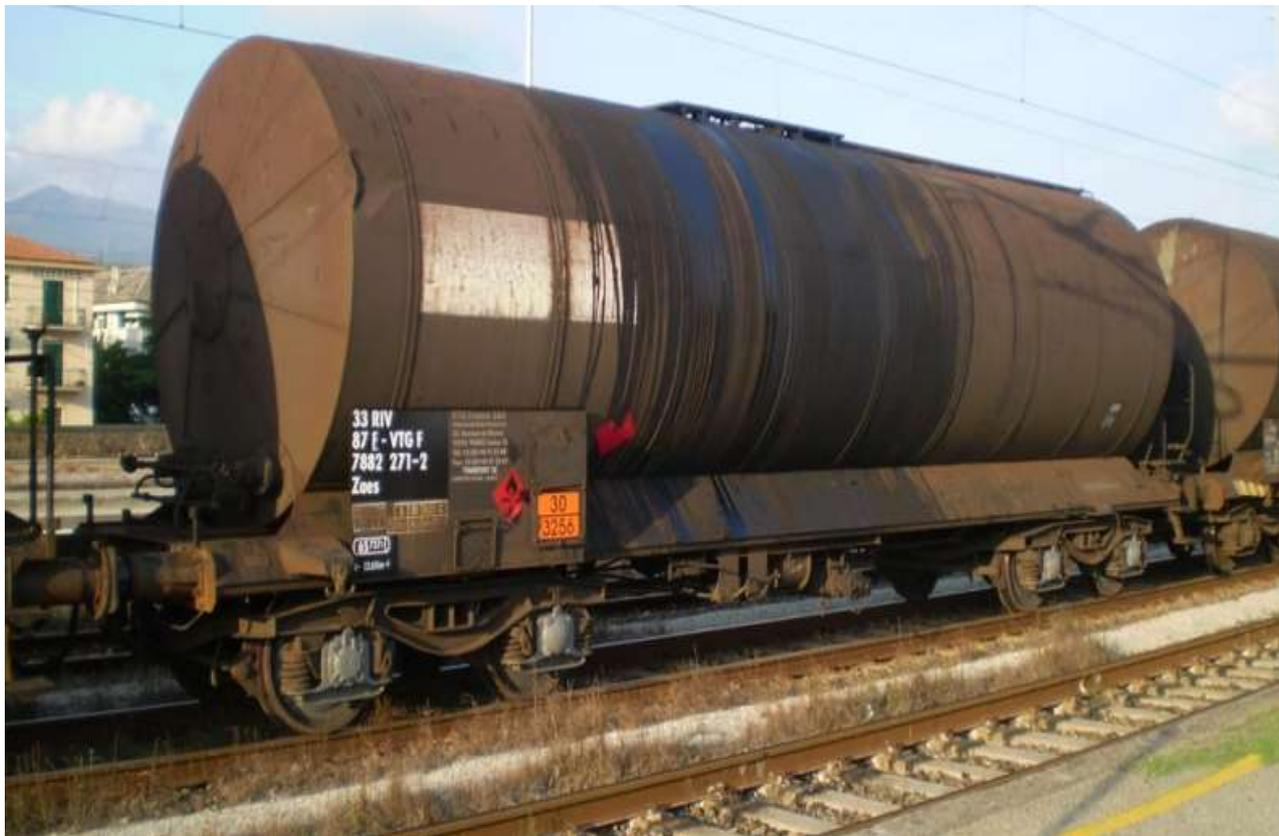
Fig. 19 – carro cisterna ZAES per trasporto prodotti petroliferi/chimici a caldo (Carro cisterna 33 87 7882 271-2 Zaes RIV F - VTG F (VTG France SAS))
