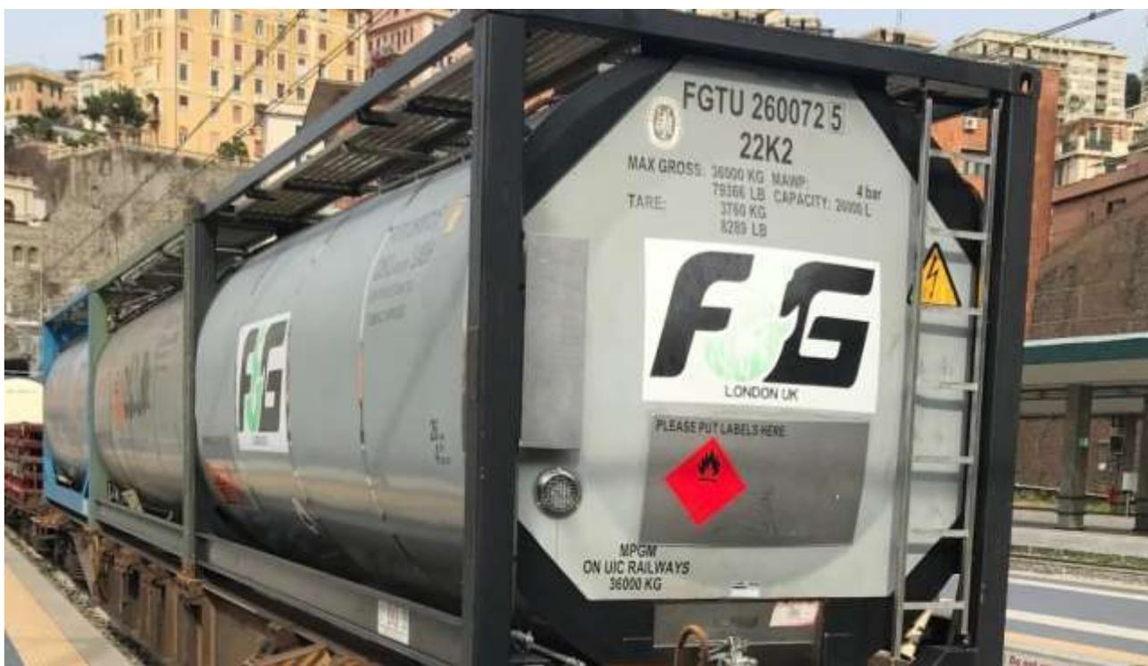
Fig. 22 - carro cisterna ZAGS per gas compresso – carro francese adibito al trasporto di GPL (carico 15 t) sosta per intervento svuotamento di emergenza Stazione di Ventimiglia (F. Quirico 03/07/2019)
