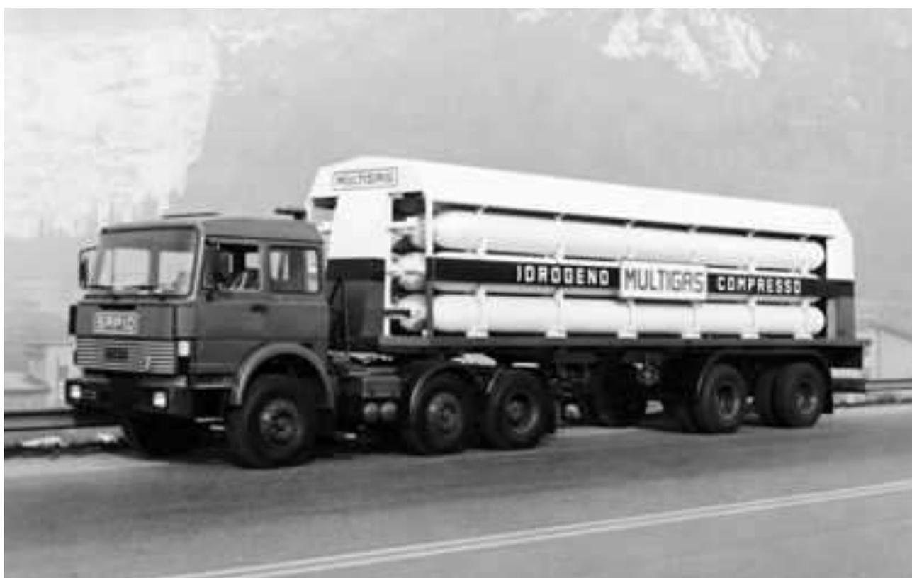
Fig. 6 “semirimorchio bombola” costituito da gruppo di bombole collegati in serie, in allestimento (tipologia risalente e non particolarmente utilizzata in ambito nazionale) adatta al trasporto di gas tecnici quali acetilene e idrogeno
