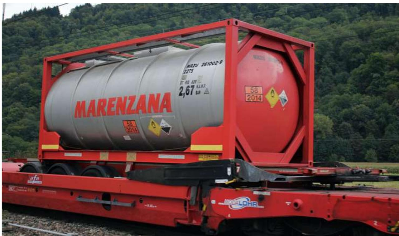
Fig. 24 - carro trasporto autocarri (semirimorchio) con "tank container "
