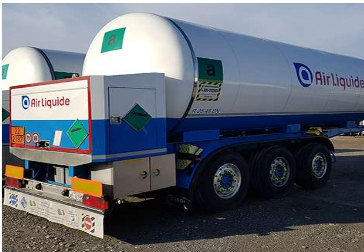
Fig. 4 - Cisterne per GPL o gas tipologia a cilindrica (semirimorchio, autocarro "botticella") per trasporto GPL, butano, ammoniaca anidra e gas tecnici in genere
