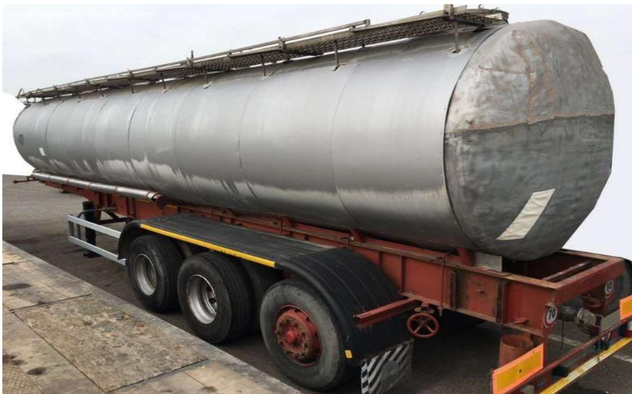
Fig. 13 – semirimorchio cisterna coibentata trasporto bitumi, emulsioni o liquidi ad alte temperature (modello obsoleto, con fasciatura)
