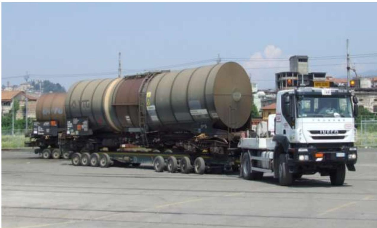
Fig. 25 – trasporto stradale (“carrellamento”) di un carro cisterna ZAES per servizio/navetta domiciliare\*
