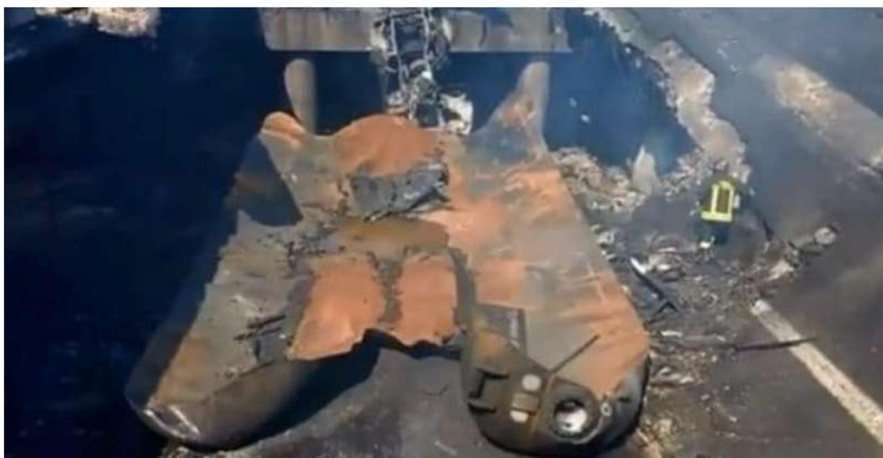
Fig. 46 - resti del semirimorchio cisterna che trasportava gas di petrolio liquefatto – evidente la rottura lungo l’itera saldatura, causata dalla sovrappressione del gas surriscaldata (Fonte Polizia di Stato)
